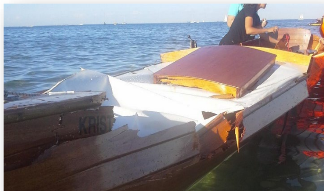
2-årrers inrigger efter kollision med en jetski.
