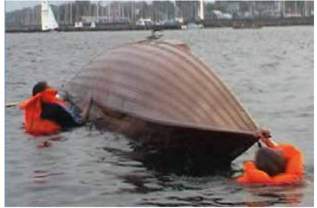
Bild 7.4b Auf das Kommando vom LStm versuchen die beiden an Bug und Heck, das Boot aus dem Wasser zu heben, während der Dritte das Boot wendet. In der Praxis werden die beiden ins Wasser gedrückt, aber mit kräftiger Beinarbeit und den Auftrieb der Rettungswesten wird das Boot leicht angehoben.
