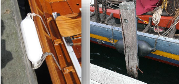
Fenderen kan evt. bindes vandret for at sidde stabilt på båden og dække så stort et område, som muligt.
