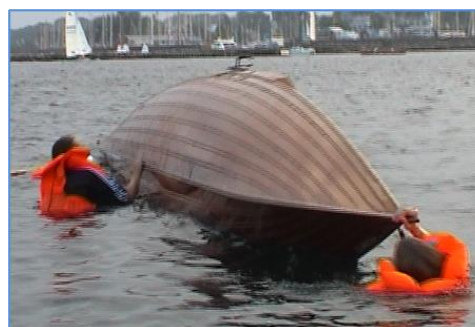
På styrmandens kommando løfter de to roere for og agter båden, mens den tredje trækker i kølen. I praksis presses de to roere ned i vandet, men med en kraftig "træde vande" og redningsvestens opdrift, bliver båden løftet, så der kommer mindre vand ind end ellers.
