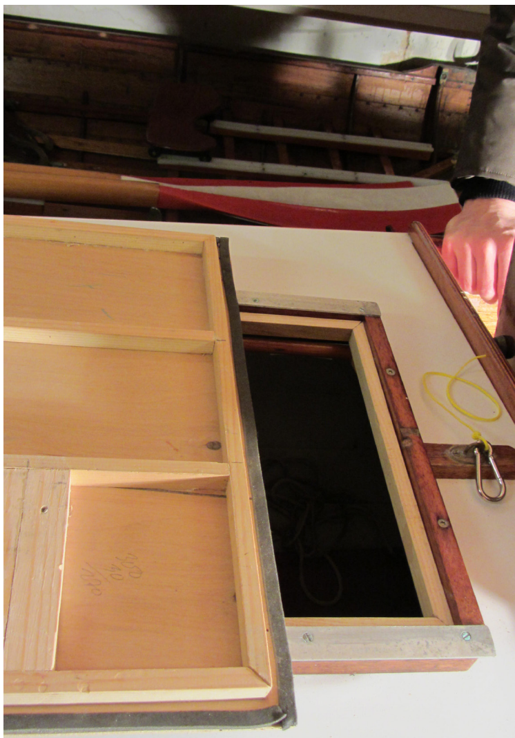
Agterluge visende bagside af ekstra luge medpakning.
