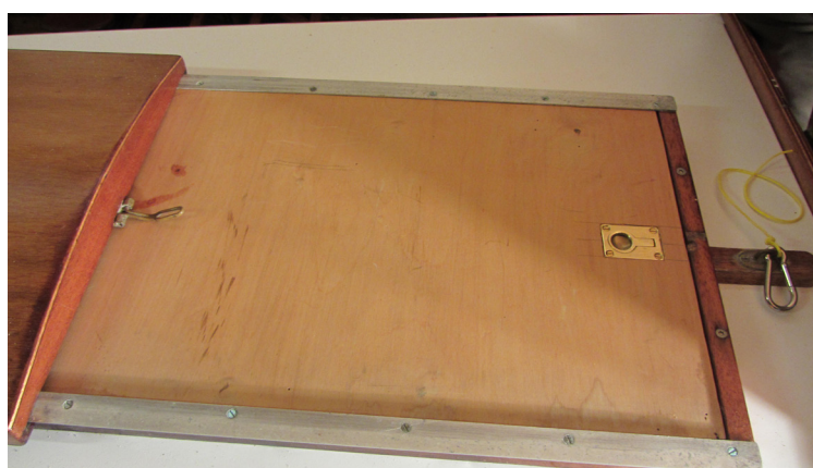
Agterluge med ekstra luge i lugeåbningen. Ekstra lugen holdes på plads af overlugen når denne er lukket. Trykkes ekstra meget ned i pakning, når der kommer vandtryk på lugen ved en kæntring
