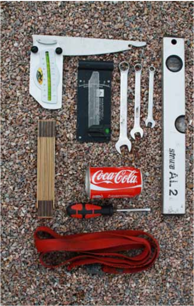
De mest essentielle værktøjer for indstilling af en båd.
