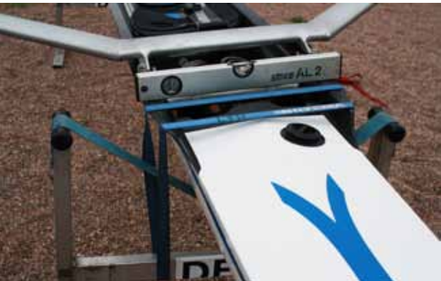
Vaterpas på karmen for at sætte båden i vatter inden måling.
