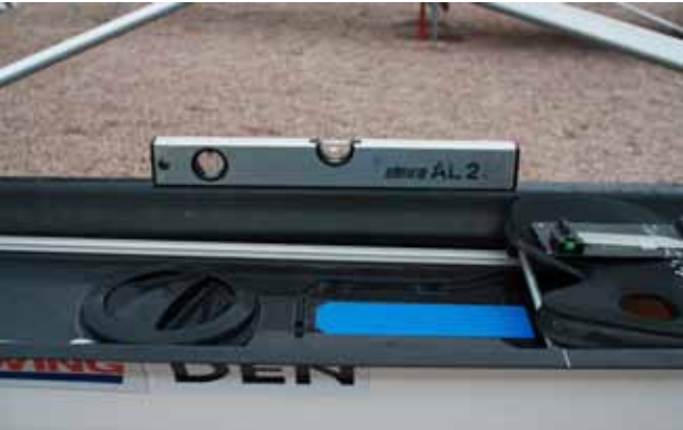
Vaterpas på karm for at sætte båden i vatter inden måling.
