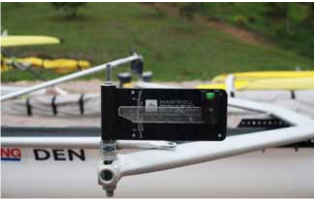
Måling af stammens vinkel i længderetningen.
