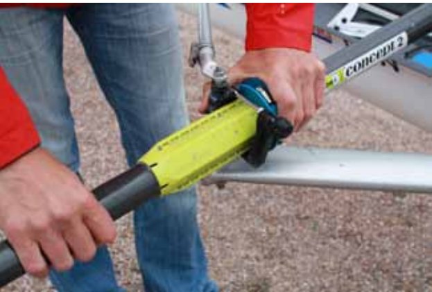
Åren holdes til anlægsfladen med en tommelfinger bag svirvlen.
