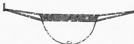
Gjennemsnit af en outrigger Finérbaad
